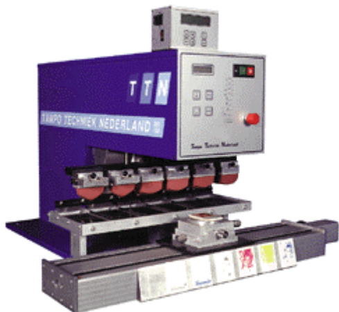
Rys. 7 Drukarka tamponowa z programowalnym, liniowym stołem przesuwным
