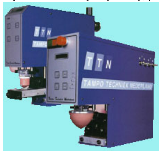
Rys. 2 – Drukarki tamponowe z liniowymi ruchami tamponu
